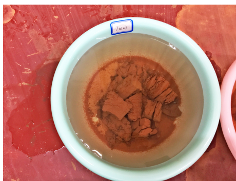
图2 静态崩解试验 (SD01) Fig.2 Static disintegration test (SD01)
